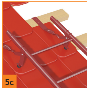
Установка кровельной лестницы на черепичную кровлю
